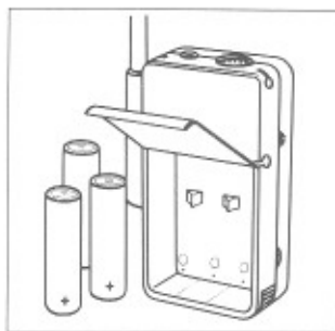
Fig. 2: Mise en place des piles
