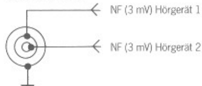
Abb. 3: Beschaltung der NF Ausgangsbuchse in Schalterstellung „3 mV“
