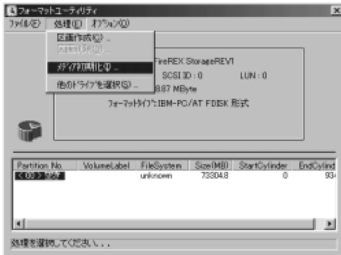
6. 初期化画面が表示されますのでIBM-PC/AT FDISK形式を選択して、[OK]をクリックしてください。
