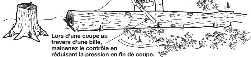
Fig. 12 Tronçonnage d'une bille qui repose au sol sur toute sa longueur
