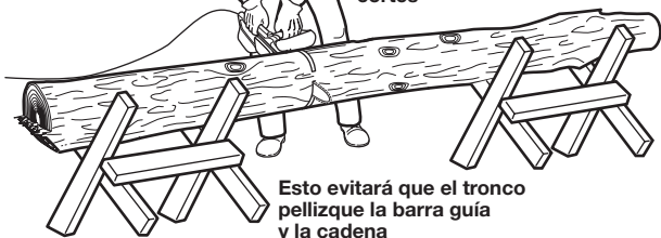
Fig.14 Cómo trozar un tronco cuando está apoyado sobre ambos extremos
