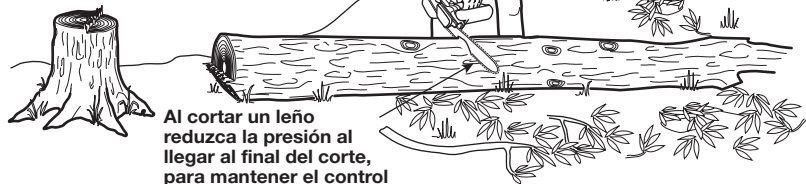
Fig.12 Cómo trozar un tronco cuando todo el largo está apoyado en el suelo
