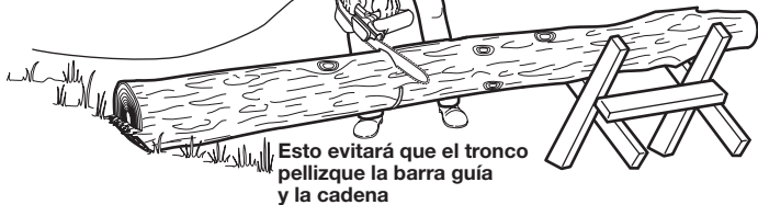
Fig.13 Cómo trozar un tronco cuando está apoyado sobre un extremo
