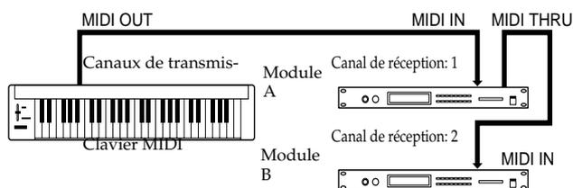
Utilisé comme module de sons, le RS-50 peut recevoir sur les seize canaux MIDI. Les modules de sons qui, à l'instar du RS-50, sont capables de recevoir simultanément sur plusieurs canaux MIDI et de piloter un son différent pour chaque canal, sont appelés "modules de sons multitimbraux".
