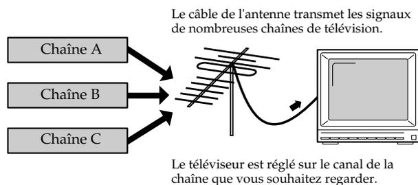
La norme MIDI utilise 16 canaux, numérotés de 1 à 16. En principe, les dispositifs récepteurs doivent être réglés pour recevoir uniquement via les canaux nécessaires.
