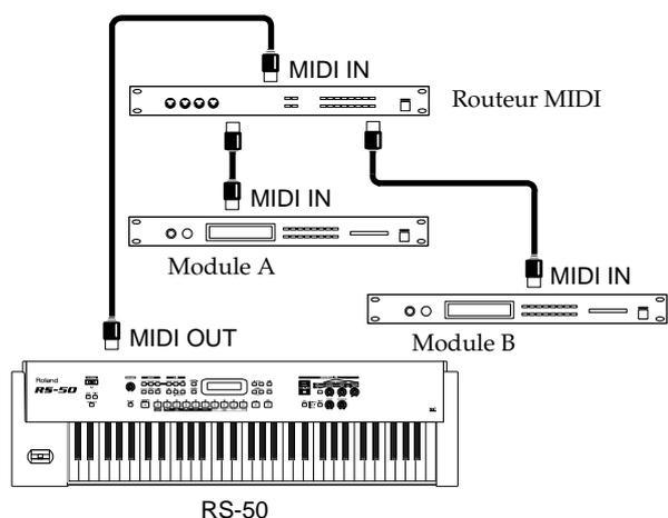
\* Si vous reliez trois dispositifs MIDI ou plus avec les connexions IN → THRU → IN → THRU ..., le signal MIDI risque de se dégrader, ce qui pourrait générer des erreurs dans les données. Dans ce cas, utilisez un routeur MIDI. Les routeurs MIDI sont des appareils qui permettent de transmettre un flux unique de données MIDI à un grand nombre de dispositifs MIDI sans produire d'erreurs dans les données.
