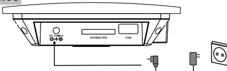
Branchez une extrémité de l'adaptateur AC fourni dans la prise DC de l'appareil, puis branchez l'autre extrémité dans la prise AC. Veuillez se référer à l'illustration ci-dessus
