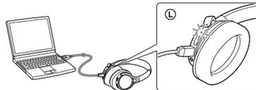
Lorsque l'appareil et l'ordinateur sont connectés, le chargement commence et le témoin (rouge) s'allume. Le chargement dure environ 2,5 heures au maximum et le témoin (rouge) s'éteint automatiquement.
