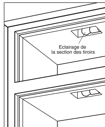
Emplacement de l'ampoule dans la section de tiroir
