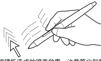
螢幕玻璃所造成的視差效果。注意筆尖和螢幕游標的位置的差異。
