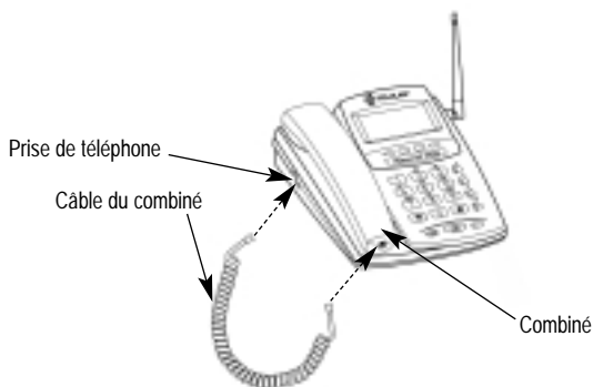
Figure 8 - Branchement du combiné du SX5D.
