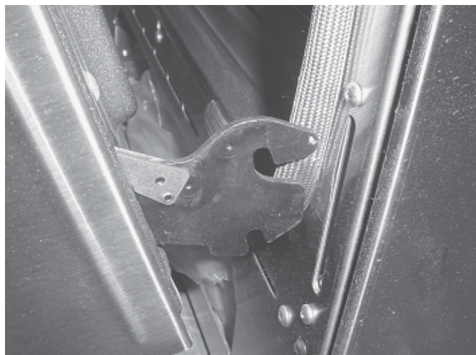
Photo D. Charnières enlevées du four.
