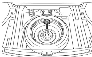
Loosen and remove the bolt.
