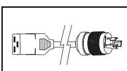
**Cordón de alimentación de entrada de CA secundaria (Modelo PDUMH20ATNET):** El cordón separable tiene un conector IEC-320-C19 y un enchufe NEMA L5-20P.
