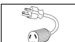
**Adaptadores de enchufe de entrada (Modelo PDUMH20ATNET):** Los adaptadores transforman los enchufes de entrada NEMA L5-20P en enchufes de entrada NEMA 5-20P.
