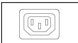
**Cordon d'alimentation d'entrée secondaire CA (Modèle PDUMH15ATNET) :** Le cordon d'alimentation d'entrée secondaire CA amovible se connecte à l'embase IEC-320-C14.
