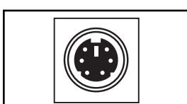
**Port PS/2 :** Utiliser ce port pour connecter un capteur environnemental ENVIROSENSE de Tripp Lite de façon à fournir une surveillance à distance de la température et de l'humidité et une interface à contact sec pour commander et surveiller les dispositifs d'alarme, de sécurité et de télécommunications. Appeler l'assistance à la clientèle de Tripp Lite au (773) 869-1234 pour des renseignements sur les commandes. Note : Ne pas connecter de clavier ni de souris à ce port.
