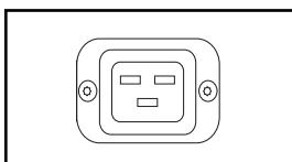
**Cordon d'alimentation d'entrée secondaire CA (Modèle PDUMH20ATNET) :** Le cordon d'alimentation d'entrée secondaire CA amovible se connecte à l'embase IEC-320-C20.
