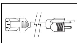
**Cordon d'alimentation d'entrée secondaire CA (Modèle PDUMH15ATNET) :** Le cordon amovible dispose d'un connecteur IEC-320-C13 et d'une fiche NEMA 5-15P.
