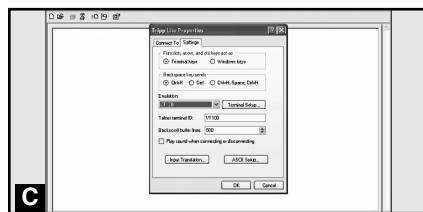
Si el programa de emulación terminal soporta diversos modos de emulación, necesitará especificar la emulación VT100 **C**.
