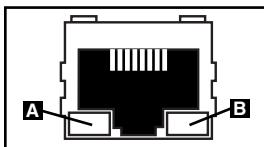
**Port Ethernet :** Utiliser cette prise RJ-45 pour connecter la PDU au réseau à l'aide d'un cordon de raccordement standard Ethernet. La DEL de lien **A** et la DEL de statut **B** indiquent plusieurs conditions de fonctionnement, comme le montre le tableau ci-dessous. *Incompatible avec les applications PoE (Power Over Ethernet).*
