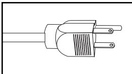
**Cordón de alimentación de entrada de CA primaria (Modelo PDUMH15ATNET):** Este cordón se encuentra conectado permanentemente a la PDU y tiene un enchufe NEMA 5-15P.
