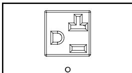
**Sorties NEMA 5-15R/20R (Modèle PDUMH20ATNET) :** Lors d'un fonctionnement normal, les sorties distribuent du courant CA à l'équipement connecté. Quand une sortie est sous tension, la DEL correspondante s'allume.
