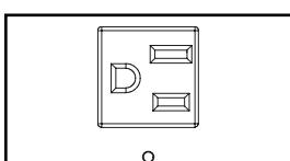
**Sorties NEMA 5-15R (Modèle PDUMH15ATNET) :** Lors d'un fonctionnement normal, les sorties distribuent du courant CA à l'équipement connecté. Quand une sortie est sous tension, la DEL correspondante s'allume.
