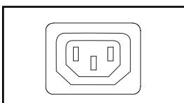
**Cordón de alimentación de entrada de CA secundaria (Modelo PDUMH15ATNET):** La entrada IEC-320-C14 se conecta al cordón de alimentación de entrada de CA secundaria separable.
