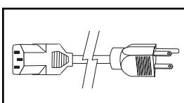
**Cordón de alimentación de entrada de CA secundaria (Modelo PDUMH15ATNET):** El cordón separable tiene un conector IEC-320-C13 y un enchufe NEMA 5-15P.
