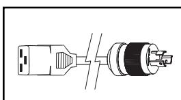
**Cordon d'alimentation d'entrée secondaire CA (Modèle PDUMH20ATNET) :** Le cordon amovible dispose d'un connecteur IEC-320-C19 et d'une fiche NEMA L5-20P.
