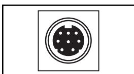
**Port série mini-DIN :** Utiliser ce port pour faire une connexion directe de terminal à un ordinateur avec un programme d'émulation de terminal. Un câble série (pièce no 73-1025) est joint à la PDU. Si vous avez besoin de commander un câble de rechange, appeler le service à la clientèle de Tripp Lite au (773) 869-1234
