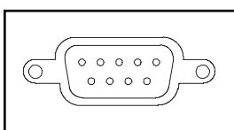
**Port d'usine :** Ce port est réservé pour la configuration en usine uniquement par du personnel autorisé. Ne rien connecter à ce port.
