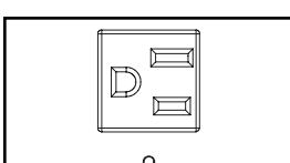
**Salidas NEMA 5-15R (Modelo PDUMH15ATNET):** Durante la operación normal, las salidas distribuyen la energía de CA al equipo conectado. Cuando hay energía en la salida, el LED correspondiente se encenderá.
