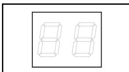
**Compteur numérique de charge (Ampèremètre) :** La totalité du courant électrique utilisée par la PDU sera affichée en ampères au compteur numérique.
