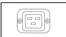
**Cordón de alimentación de entrada de CA secundaria (Modelo PDUMH20ATNET):** La entrada IEC-320-C20 se conecta al cordón de alimentación de entrada de CA secundaria separable.
