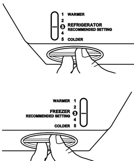
**REMARQUE :** Pour régler la commande du réfrigérateur à OFF (arrêt), tourner le réglage au-delà de Warmer (plus tiède) jusqu'à ce que le mot OFF (arrêt) apparaisse, comme indiqué ci-dessous. Votre appareil ne se refroidira pas lorsque la commande du réfrigérateur est réglée à OFF (arrêt).
