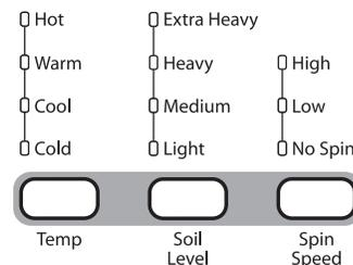
Après avoir sélectionné un programme, les réglages par défaut correspondant à ce programme s'allument. Appuyer sur les boutons de réglage du programme pour modifier le niveau de saleté et la vitesse d'essorage la température si désiré.
