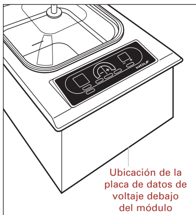
Ubicación de la placa de voltaje
