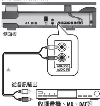
使用顯示裝置的 **F.AUDIO** 輸入插孔可輕易播放數位音訊播放器或 PC 的音效。使用立體聲迷你插頭連接線將音訊來源連接至顯示裝置。
