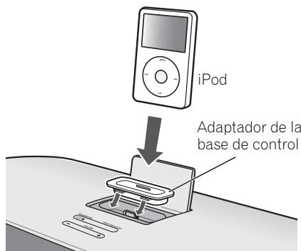
**1 Conecte el adaptador de la base de control al puerto del conector del iPod que hay en el panel superior de esta unidad.**
