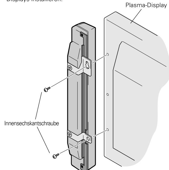
Die mit "LEFT" markierte Einheit an der linken Seite des Displays installieren.
