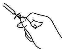
2. Druk het hendeltje omlaag en steek de kabel in de aansluiting. Laat het hendeltje los.
