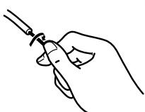
2. Appuyer sur le levier, introduire le câble dans le trou, et relâcher le levier.
