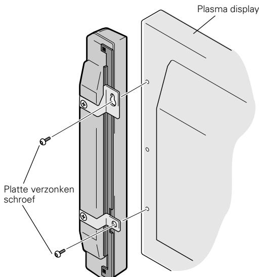
① Om de luidsprekers aan het scherm te bevestigen, plaatst u eerst de bovenste schroef op de aangeduide plaats en draait u ze vast tot er nog een speling is van ongeveer 5 mm tussen de schroefkop en het scherm.
