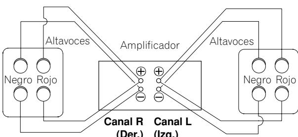
**1 Afloje los bornes de los terminales de entrada izquierdos y extraiga las dos barras cortocircuitadoras.**
