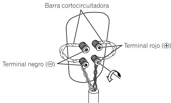
**3 Conecte el otro extremo del cable a los terminales de salida de altavoz en el amplificador, en el canal asignado a al altavoz y manteniendo la polaridad (para más detalles al respecto, consulte el manual de instrucciones del amplificador).**
