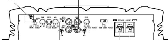
Le commutateur MODE SELECT doit être sur la position SYNC.
