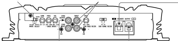
El interruptor MODE SELECT debe estar en la posición SYNC INV. Antes de ajustar a la posición, quite el tornillo y el retenedor.
