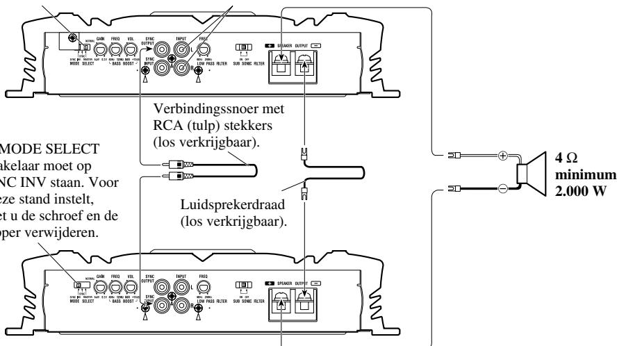
De MODE SELECT schakelaar moet op SYNC INV staan. Voor u deze stand instelt, moet u de schroef en de stopper verwijderen.
