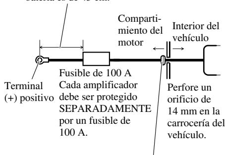
Inserte el ojal de caucho de la junta tórica en la carrocería del vehículo.
