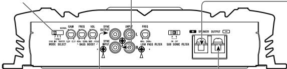
MODE SELECT doit être sur la position SYNC INV position. Avant de le placer sur cette position, retirez la vis et la butée.
