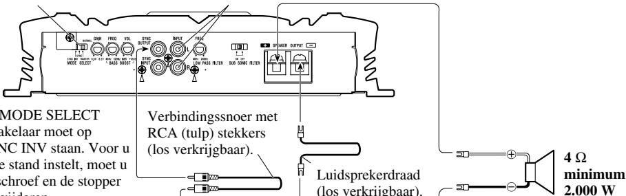
De MODE SELECT schakelaar moet op SYNC INV staan. Voor u deze stand instelt, moet u de schroef en de stopper verwijderen.
