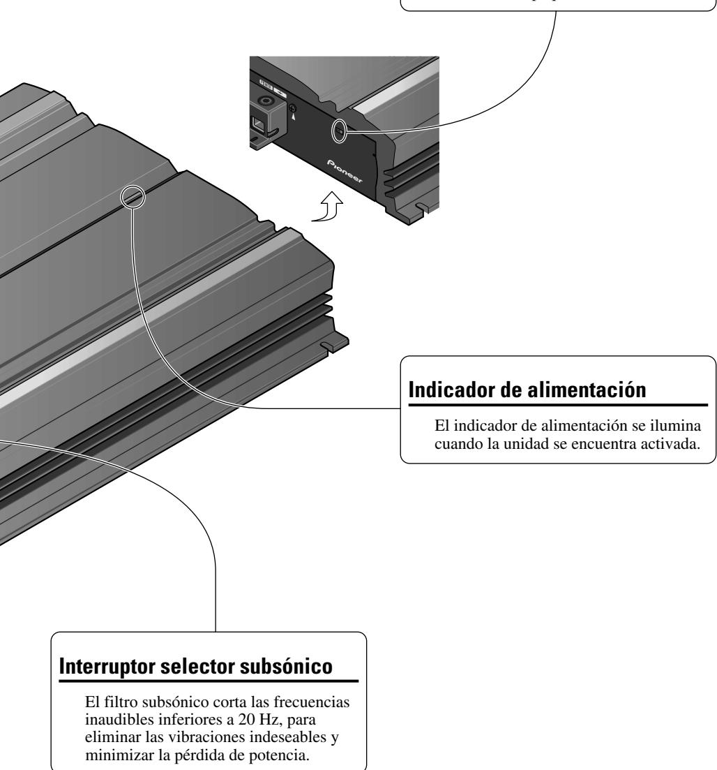
El filtro subsónico corta las frecuencias inaudibles inferiores a 20 Hz, para eliminar las vibraciones indeseables y minimizar la pérdida de potencia.
