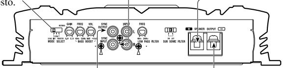
Il commutatore MODE SELECT deve trovarsi nella posizione SYNC INV. Prima di impostare la posizione rimuovere la vite ed il dispositivo di arresto.
