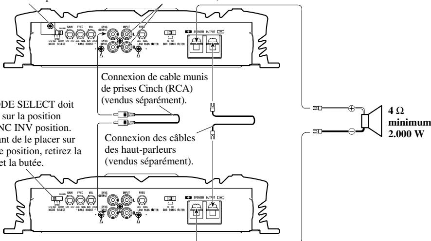
MODE SELECT doit être sur la position SYNC INV position. Avant de le placer sur cette position, retirez la vis et la butée.
