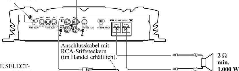
Der MODE SELECT-Schalter muss sich in der Position SYNC befinden.
