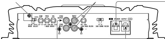
MODE SELECT doit être sur la position SYNC INV position. Avant de le placer sur cette position, retirez la vis et la butée.
