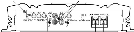
Le commutateur MODE SELECT doit être sur la position SYNC.
