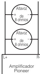
Modo de conexión en puente de 4 ohmios
