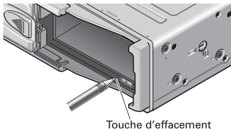
Après avoir terminé les connexions, appuyer sur la touche d'effacement avec la pointe d'un crayon. Si l'appareil n'est pas mis sous tension, si le lecteur de disque compact ne fonctionne pas lorsque la touche de l'unité de commande est enfoncée ou si l'affichage de l'unité de commande est incorrect, appuyer sur cette touche avec la pointe d'un crayon pour rétablir l'opération normale. (Ce bouton est placé à l'intérieur de la porte.)
