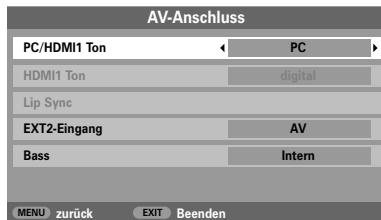
**HINWEIS:** Durch Auswahl der Option **PC** wird die HDMI-Schnittstelle (High-Definition Multimedia Interface) in den digitalen Audiomodus geschaltet.
