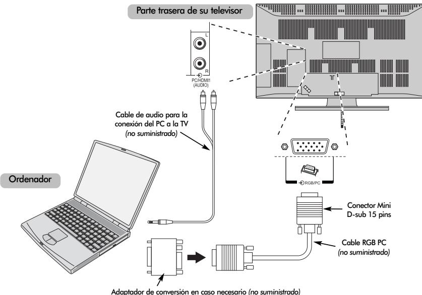
Conecte el cable de PC del ordenador al terminal PC en la parte trasera de la televisión.
