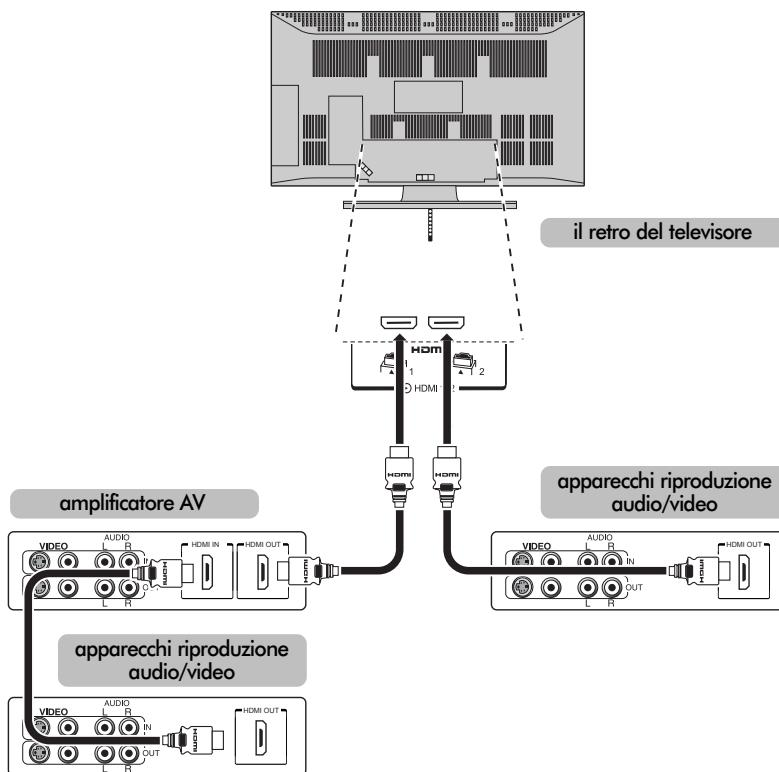
**NOTA:** al fine di un corretto funzionamento, si consiglia di collegare tutti gli apparecchi audio/video con cavi HDMI riportanti il logo HDMI (**HDMI**). Ove si colleghino diversi apparecchi, la funzione REGZA-LINK potrebbe non operare correttamente.
