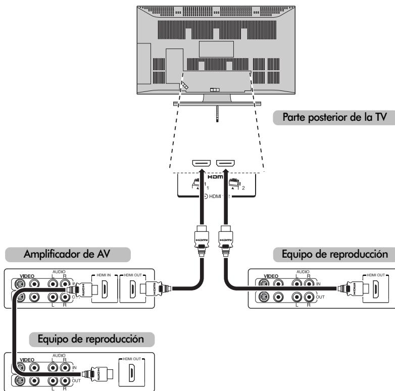
**NOTA:** se recomienda que para un funcionamiento correcto, todos los dispositivos de audio/video se conecten utilizando cables HDMI con el logo HDMI (**HDMI**). Si se conectan varios dispositivos, es posible que la función REGZA-LINK no funcione correctamente.
