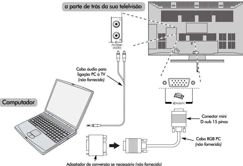
Ligue o cabo do PC entre o computador e o terminal PC na parte de trás do televisor.
