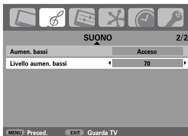
Collegando un Super Woofer attivo alla connessione Uscita Woofer sul retro del televisore, selezionare **Connessione AV** dal menu di **IMPOSTAZIONI**, premere ▼ per selezionare **Woofer** e quindi, mediante ◀ o ▶, selezionare **Esterno**. (Vedere la sezione 'Selezione dell'ingresso e connessioni AV').
