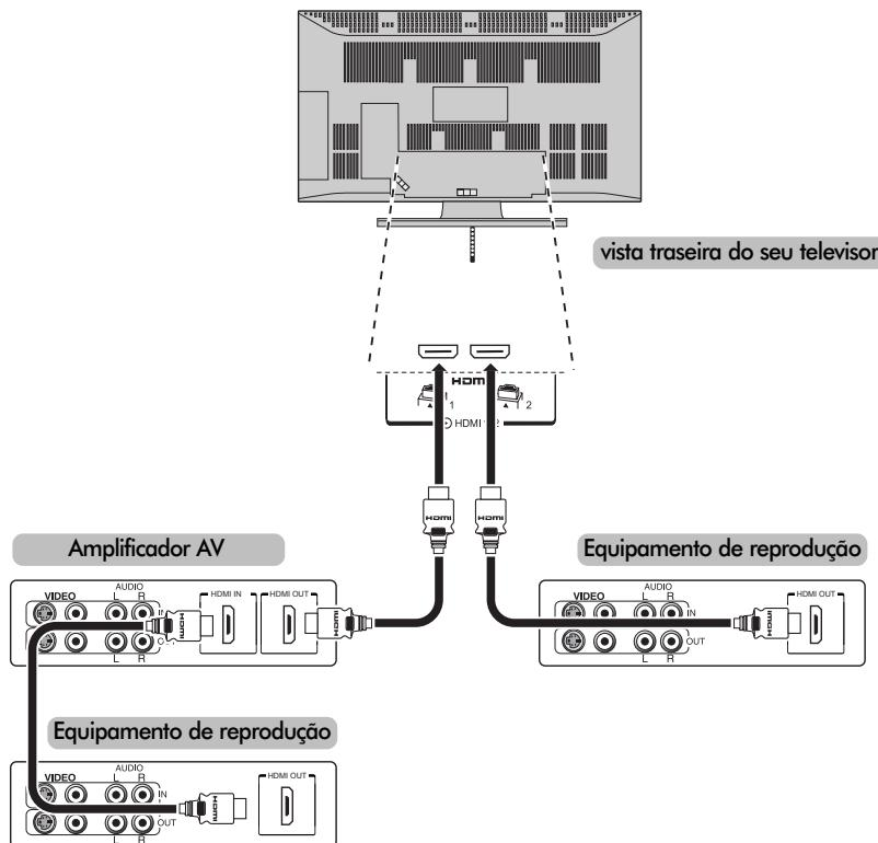
**Nota:** Recomenda-se que, para um funcionamento correcto, todos os aparelhos áudio/video estejam conectados usando cabos HDMI com o logótipo HDMI (**HDMI**). Caso vários aparelhos estejam conectados, a função REGZA-LINK poderá não funcionar correctamente.
