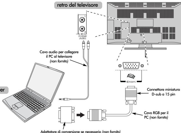
Collegare il cavo del PC proveniente dal computer al terminale PC sul retro del televisore.
