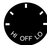
Bouton de commande du ventilateur d'aération
