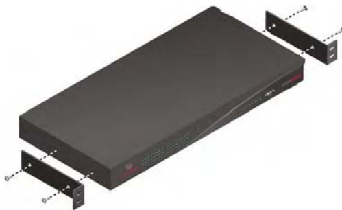
Figure 2.5 : Schéma de montage en rack du commutateur AMX
