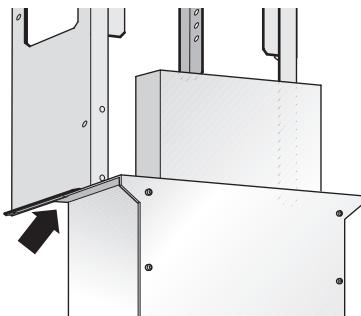
9. Atornillar la campana extractora al bastidor de soporte; colocar y atornillar el revestimiento en su sitio.
