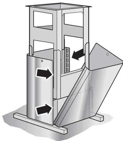
15. Deslizar el elemento superior del revestimiento de chimenea hacia arriba y atornillarlo.
