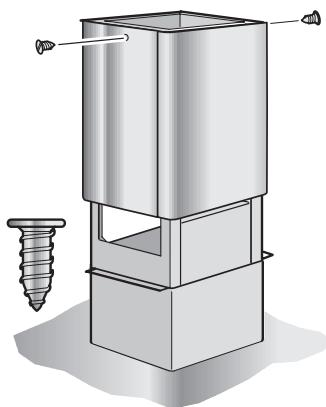
16. Insertar los dos elementos del revestimiento de chimenea inferior y fijarlos mediante los clips correspondientes.
