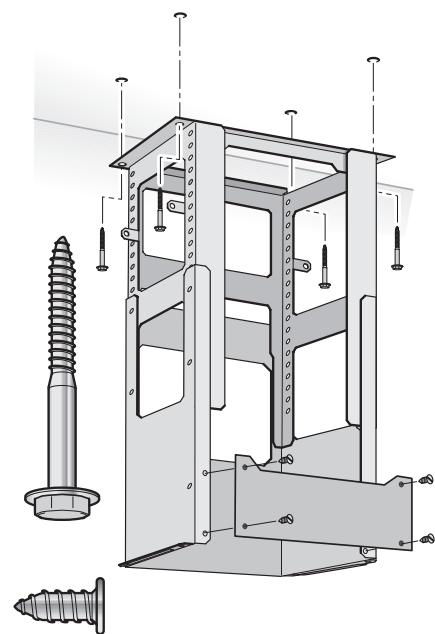
8. Introducir la campana en el bastidor de soporte con ayuda de los elementos auxiliares de montaje.
