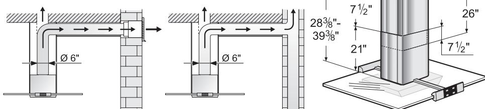
L'air vicié est évacué vers le haut par un conduit d'aération ou directement à l'air libre par traversée du mur extérieur.
