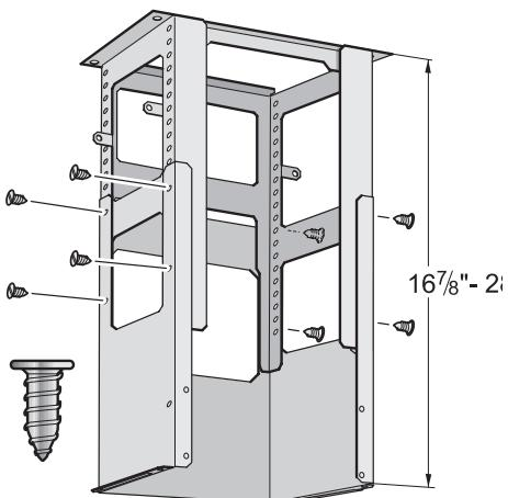
6. Fijar el bastidor de soporte al techo con 4 tornillos.
