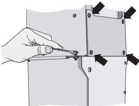
10. Alinear la campana extractora, soltando para ello previamente los tornillos de fijación al techo del bastidor de soporte.
