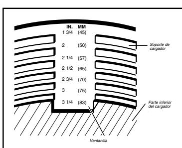
**NOTA:** Use sólo clavos recomendados por Bostitch para uso en las clavadoras de la serie N80CB de Bostitch o clavos que cumplan con las especificaciones de Bostitch.
