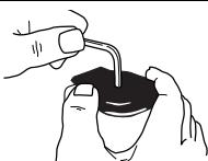
Desserrer la vis comme indiqué. Régler en fonction de la direction d'échappement souhaitée, puis resserrer la vis.
