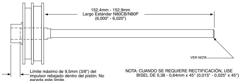
**NOTA:** Un desgaste del impulsor de aproximadamente 3mm (1/8") se puede tolerar para la mayoría de las aplicaciones. Sin embargo, para aplicaciones de impulsión difíciles, un desgaste del impulsor de aproximadamente 1,5 mm (1/16") puede causar una ligera reducción en la potencia de impulsión aparente.
