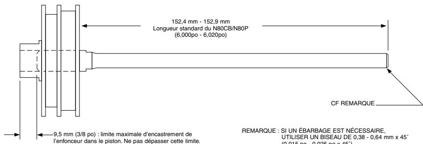
**REMARQUE :** Dans la plupart des utilisations, une usure de 3 mm (1/8 po) de l'enfonceur peut être tolérée. Néanmoins, dans le cas d'une utilisation plus complexe, une usure d'environ 1,5 mm (1/16 po) peut provoquer une légère réduction de la puissance apparente d'enfoncement.
