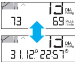
Hafızadaki ölçümleri görmek için, ilk olarak cihazı kapayın, sonra hafıza düğmesine (D) basın. Bir kerelik basım (◀ ya ▶) en son ölçümü gösterecektir. Daha aşağıdakiler ekran çizgisi bir tarafta ardı ardına hafızaya alınmış ölçümü ve nabız atışını, diğer tarafta da bu ölçümün tarih ve zamanını gösterir.
