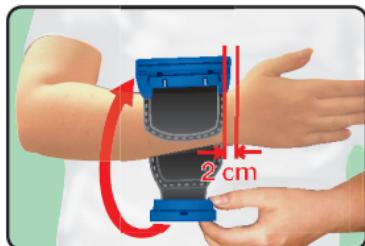
1. Alezați corpul aparatului pe partea interioară a antebrațului dumneavoastră, cu față în sus. Distanțierul vă ajută să păstrați cei 2 cm distanță până la linia palmei.
