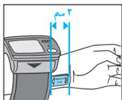
٢ - لإغلاق الطوق، قرب الجهاز من جسمك، ثم أمسك أداء إغلاق الطوق وشد الطوق وأدخل أداء إغلاقه في غطاء الجهاز حتى يغلق في مكانه. ينضبط طول الطوق أوتوماتيكياً حول معصمك. بعد إغلاق الطوق، تجنب تحريك الجهاز، وإذا أردت تغيير وضع الجهاز على ذراعك، فقم بفتح الطوق وإغلاقه مرةً أخرى.
