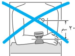
وهكذا، يحتوي جهاز براون سينسور كنترول على نظام تحديد الوضع الفعلي (A) : وهو يوجه خطوة بخطوة لوضع ذراعك التي تقيس بها في الموضع الصحيح عند مستوى القلب.
