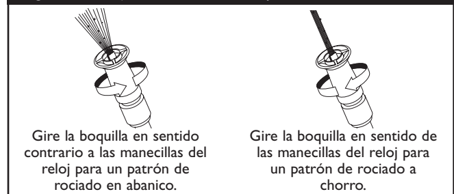
Figura 27 — Ajustar el Patrón de Aspersión
