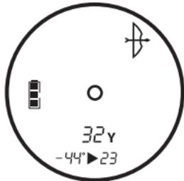
Quando sono visualizzate le distanze della linea di vista da 5 a 99 yarde, l'indicatore della modalità freccia sarà automaticamente visualizzato assieme all'angolo e alla distanza compensata. Se sono visualizzate distanze superiori a 99 yarde, l'indicatore della modalità freccia si spegnerà automaticamente assieme all'angolo e alle distanze compensate.
