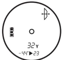
Cuando se muestran distancias de la línea de visión de 5 a 99 yardas, se podrá observar automáticamente el indicador del modo Bow (arco) junto con el ángulo y una distancia compensada. Si se muestran distancias superiores a 99 yardas, el Indicador del modo Bow (arco) se apagará automáticamente, junto con el ángulo y las distancias compensadas.
