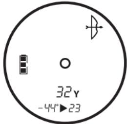
**Remarque:** Nous avons regroupé l'ensemble des fonctions les plus utilisées et les avons intégrées à un appareil simple à utiliser et ne comportant qu'un seul bouton. Ce télémètre laser fonctionne toujours en mode Tir à l'Arc sur une distance comprise entre 5 et 90 mètres. L'appareil affiche une distance de ligne de mire uniquement pour les objets acquis à plus de 90 mètres.
