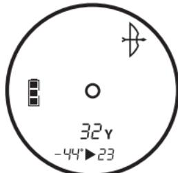
Quando a linha de distâncias de visada de 5 a 99 jardas for exibida, o indicador do modo Arco será automaticamente exibido junto com o ângulo e uma distância compensada. Se distâncias maiores do que 99 jardas forem exibidas, o indicador do modo Arco será automaticamente desligado junto com o ângulo e as distâncias compensadas.
