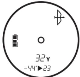
Wenn Visierlinienentfernungen von 5-99 Yards angezeigt werden, wird die Bogen-Modusanzeige automatisch zusammen mit dem Winkel und einer kompensierten Entfernung angezeigt. Wenn Entfernungen von über 99 Yards angezeigt werden, schaltet die Bogen-Modusanzeige automatisch zusammen mit dem Winkel und kompensierten Entfernungen aus.
