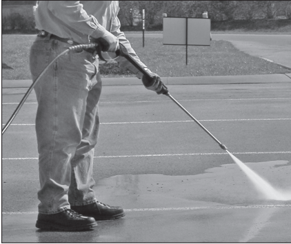
Figura 11 - Mejor ángulo de limpieza de superficies
