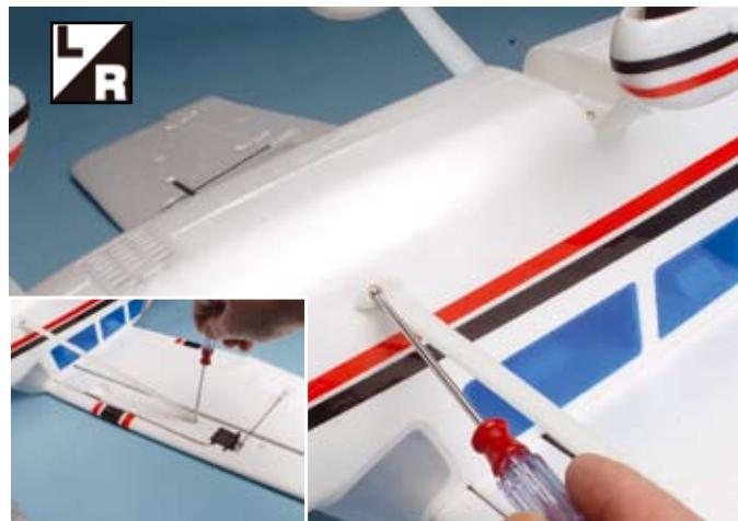
Connectez vos allonges de servos en place. Faites les passer dans le fuselage.
