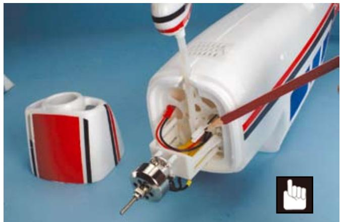
Vorderne Fahrwerk montieren und die Anlenkung mit dem Landegestell verbinden wie abgebildet.
