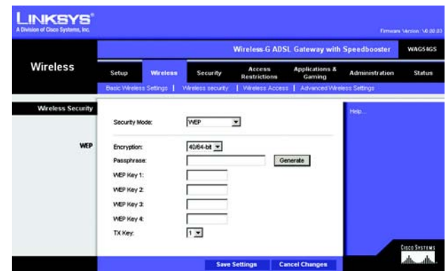
Figure 6-19 : Wireless Security - WEP (Sécurité sans fil - WEP)
