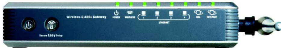
Abbildung 3-2: LEDs an der Geräteseite
