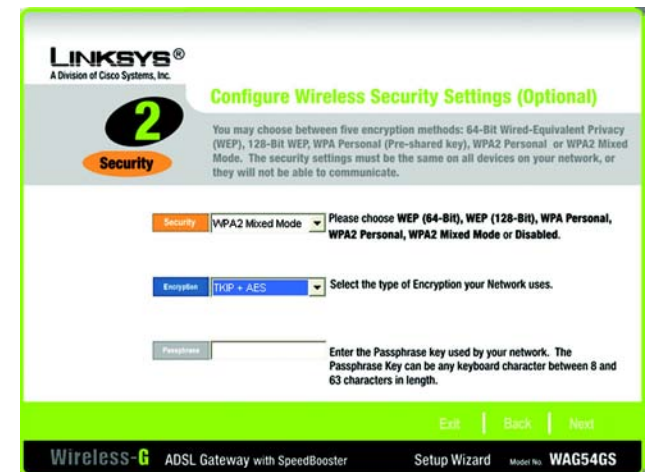
Figure 5-29 : Ecran Wireless Security - WPA2 (Sécurité sans fil - WPA2) de l'Assistant de configuration
