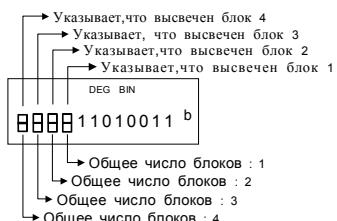
Функция блоков использует верхние и нижние индикаторы блоков.
