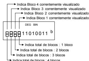
A função em blocos comprehende indicadores em blocos superiores e inferiores. O indicador superior significa posição do bloco atual, e o indicador inferior significa total de blocos para um resultado.
