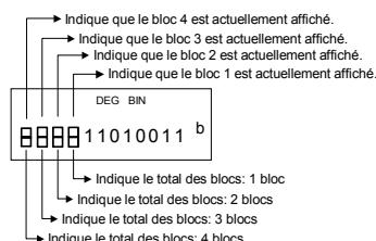
La fonction de bloc comporte des indicateurs de bloc haut et bas. L'indicateur du haut montre la position actuelle du bloc, et l'indicateur du bas montre le total des blocs pour un résultat.
