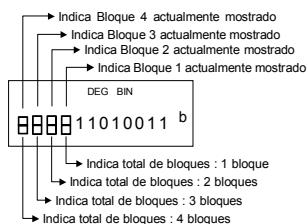
La función de bloque consta de indicadores superiores e inferiores. El indicador superior significa posición de bloque actual, y el indicador inferior significa total del bloque para el resultado.
