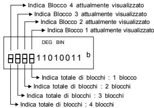
La funzione di blocco comprende gli indicatori superiore ed inferiore. Il indicatore superiore significa posizione di blocco attuale, ed il indicatore inferiore significa totale di blocchi per un risultato.
