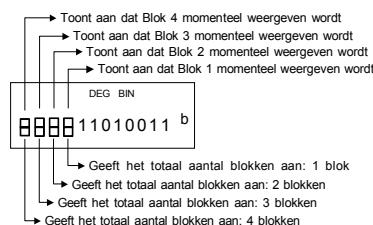
De blokfunctie bestaat uit bovenste en onderste blokindicatoren. De bovenste blokindicator duidt de huidige blokpositie aan en de onderste blokindicator duidt het totaal aantal blokken van het resultaat aan.
