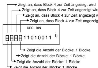
Die Block-Funktion besteht aus oberen und unteren Blockindikatoren.
