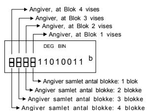
Blokfunktionen omfatter øvre og nedre blokindicatører. Den øvre indikatorer repræsenterer den aktuelle blokposition, and og den nedre indikator repræsenterer det samlede antal blokke for et resultat.
