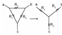
$R_4 = \frac{R_1 \cdot R_2}{R_1 + R_2 + R_3}$ $R_5 = \frac{R_2 \cdot R_3}{R_1 + R_2 + R_3}$ $R_6 = \frac{R_3 \cdot R_1}{R_1 + R_2 + R_3}$ |                       |                  |
