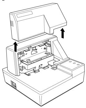
☐ Zum Schließen die Abdeckung wieder nach unten aufsetzen. Vorsichtig aufdrücken, bis sie hörbar einrastet.
