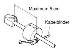
Das Befestigungsband um das Kabel wickeln und sperren. Schneiden Sie überschüssiges Band mit einer Schere ab.
