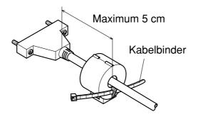
Führen Sie den Kabelbinder um das Kabel und sperren Sie ihn. Schneiden Sie überschüssiges Band mit einer Schere ab.
