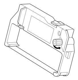
Die Farbbandkassette so halten, daß das Farbband nach unten weist und die Kassette in den Drucker einsetzen, wie in der Abbildung gezeigt.
