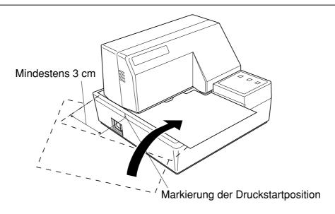
Schieben Sie die rechte Ecke des Blattes in den Drucker, bis Sie einen Widerstand spüren. Zu diesem Zeitpunkt wird die Anzeige PAPER OUT ausgehen und der Druckermechanismus zieht das Blatt automatisch ein und richtet es an der Druckstartposition aus.
