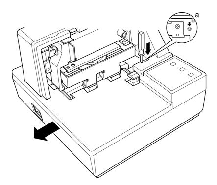
Die Papierauflage braucht hierzu nicht vollständig entfernt zu werden. Er genügt die Auflage soweit zur Seite zu schieben, bis die DIP-Schalter zugänglich sind.
