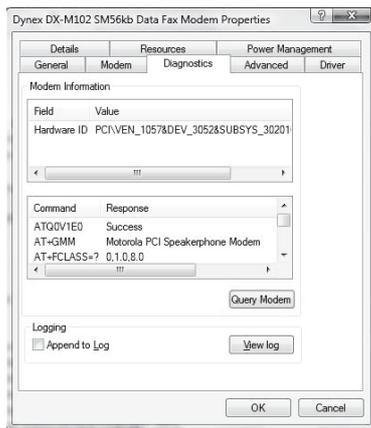
5 Dentro de unos segundos, aparecerá una ventana con las respuestas del módem a los distintos comandos AT que se le enviaron. Cuando esto sucede, el software del módem se instaló sin problemas y está funcionando correctamente.
