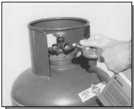
Regulador con orificio de ventilación hacia abajo
