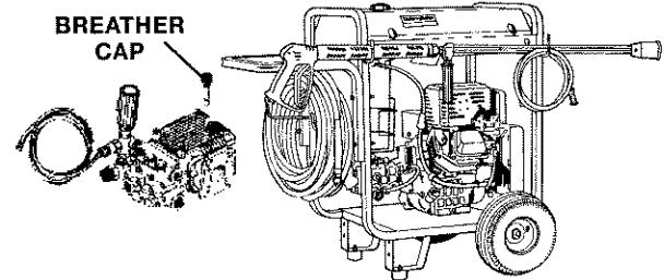
**▲ CUIDADO:** Omitir reemplazar el tapón por la tapa respiradora puede causar daños serios a la bomba.
