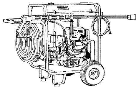
**NOTA:** Esta unidad ha sido despachada de fábrica con un tapón temporal en la bomba que debe reemplazarse con una tapa respiradora. Este tapón está ubicado en la toma de aceite de la bomba. Desenroscar el tapón para sacarlo. Sacar la tapa respiradora de la bolsa adherida al tapón e instalarla en la toma de aceite de la bomba.
