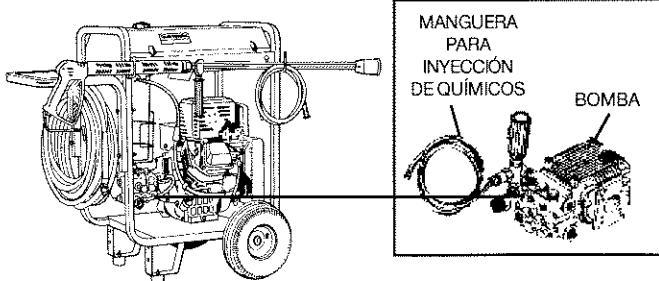
8. Conectar la manguera para alta presión al acople de conexión rápida en la salida de la presión en la lavadora.
