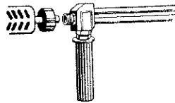
6. Cortar el amarre de la manguera para alta presión. Desenrollar la manguera y conectar el extremo roscado a la pistola.
