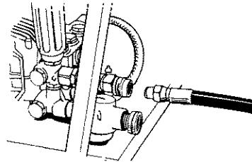
**NOTA:** Siempre mantener la manguera alejada del tubo de escape del motor.
