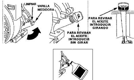
**NOTA:** Cuando se agregue aceite al cárter, usar aceite detergente de alta calidad clasificado "Para servicio SF, SG, SH, de grado SAE 30". No usar aditivos especiales. Seleccionar el grado de viscosidad del aceite de acuerdo con las temperaturas de operación que se esperen tener.
