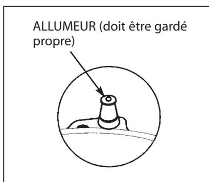
Si un brûleur ne se rallume pas, écoutez s'il y a un dé clic. Si l'allumeur ne clique pas, ÉTEIGNEZ LE BRÛLEUR. Vérifiez dans le panneau à disjoncteurs si un fusible est grillé ou un disjoncteur s'est déclenché. Si l'allumeur ne fonctionne toujours pas, consultez la page 28, « Avant d'appeler le service technique ». Pour allumer le brûleur manuellement, consultez la page 27.
