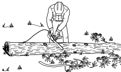
Figure 14 - Tronçonnage d'une bille qui repose entièrement au sol
