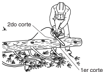
Figura 15 - Trozado del tronco apoyado sobre un solo extremo
