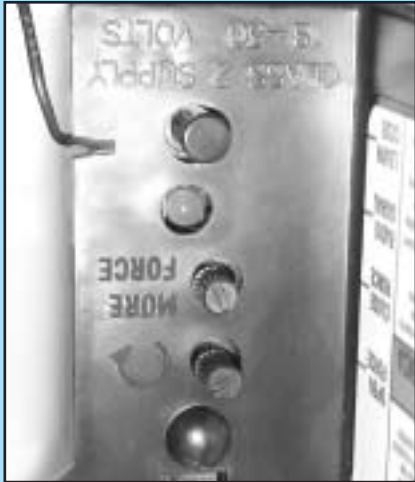
FIG. 6-1 Vis de réglage de la force Tornillos de ajuste de la fuerza.
