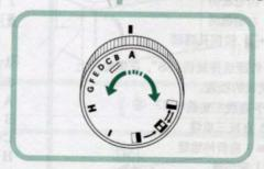
进行花型选择时须先停机器,使机针离开缝料,若选定一种线迹缝纫,旋转花型选择旋钮,使代表该线迹的字符与定位标记相对。图示选择"A",表示进行直线缝。
