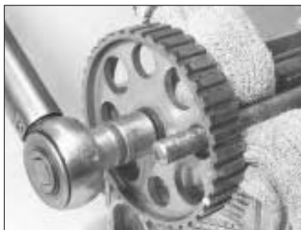
5B.22A Unscrewing the camshaft sprocket bolt
