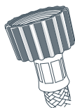
Dibujo 3 Extremo de la manguera que va conectado a la llave del agua
