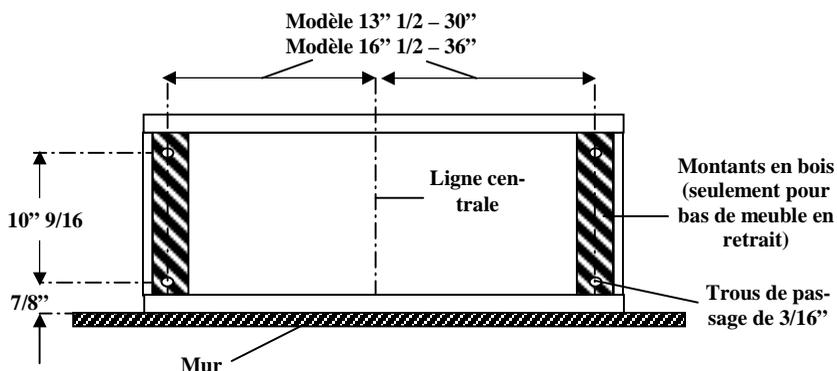
2. Ajouter les montants en bois nécessaires au bas du meuble. Percer quatre avant-trous de 3/16'' pour les vis de montage de la hotte.
