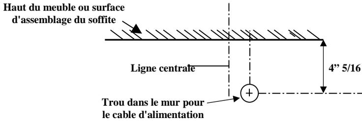
4. Percer un trou de 1" 1/4 pour le câble d'alimentation. Faire passer le câble en respectant le Code national de l'électricité ou les normes de l'Association canadienne de normalisation et les codes et ordonnances locaux. Le câble d'alimentation doit être assez long pour joindre la hotte et la boîte de dérivation. Calfeutrer pour boucher tous les trous.
