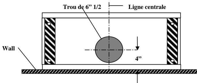
3. Percer un trou de 6 1/2'' de diamètre au bas du meuble tel que démontré.
