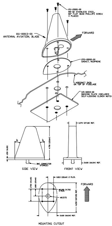
FIGURE 3-1 BLADE ANTENNA INSTALLATION
