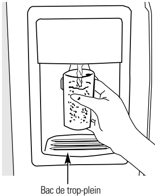
Bac de trop-plein
