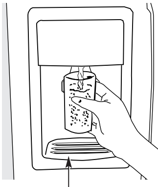
Bac de trop-plein
