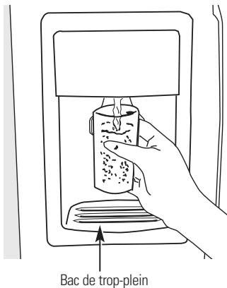
Bac de trop-plein
